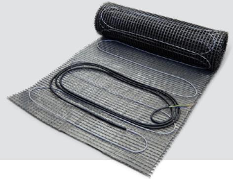
Abrollen der Heizbahnen, gemäß Verlegeplan, beginnend beim Leerrohr. Am Raumende das Glasgittergewebe einschneiden, umklappen und dann gegenläufig zurückrollen. Auf keinen Fall das Heizkabel durchtrennen. Führen Sie den Temperaturfühler des Thermostats durch das Fühlerrohr bis zum Ende, welches vorher verschlossen wurde. Führen Sie nun den Kaltleiter durch ein weiteres Leerrohr (nicht im Lieferumfang enthalten) zur Unterputzdose (Fühlerleitung im anderen Leerrohr).
